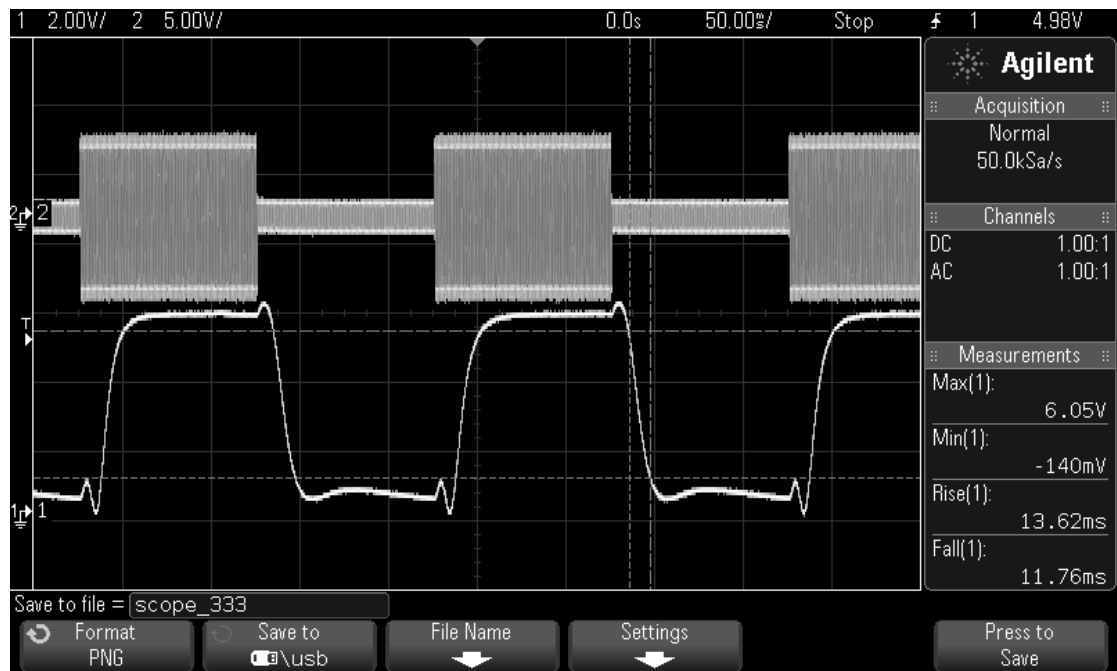
利用訊號產生器產生控制訊號及液晶光電響應量測圖
